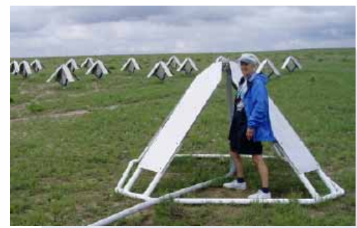
Big Blade power pattern (BBP) with ground screen 3m x 3m (N. Paravastu)
